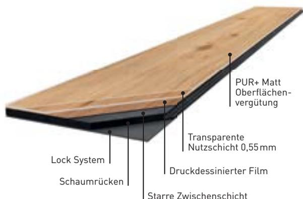
RIGID 55 LOCK ACOUSTIC ist ein Rigid-Core-Design-Bodenbelag, der dank seines Lock Systems schnell und einfach lose verlegt werden kann. Die spezielle Rigid Core Technology (spezielle starre Zwischenschicht) bietet eine sehr hohe Dimensionsstabilität und die Möglichkeit die Planken und Fliesen z.B. auch auf keramischen Fliesen (Fugenbreite max. 6 mm) zu verlegen.
