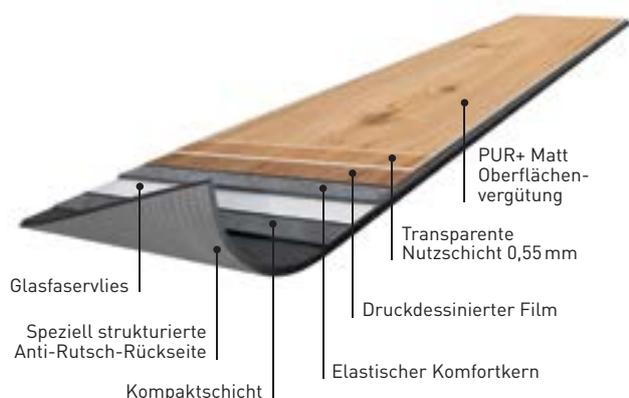
CREATION 55 LOOSELAY ist ein hochwertiger elastischer Design-Bodenbelag mit spezieller Rückenstruktur für eine schnelle und unkomplizierte Verlegung ohne Klebstoffeinsatz. Die Verlegung der CREATION 55 LOOSELAY Planken und Fliesen im Verbund kombiniert mit dem hohen Eigengewicht und der speziell strukturierten Rückseite gewährleisten die Funktionalität der Bodenfläche. Der Belag ist auch wieder einfach zu entfernen, ohne Rückstände auf dem Untergrund zu hinterlassen.
