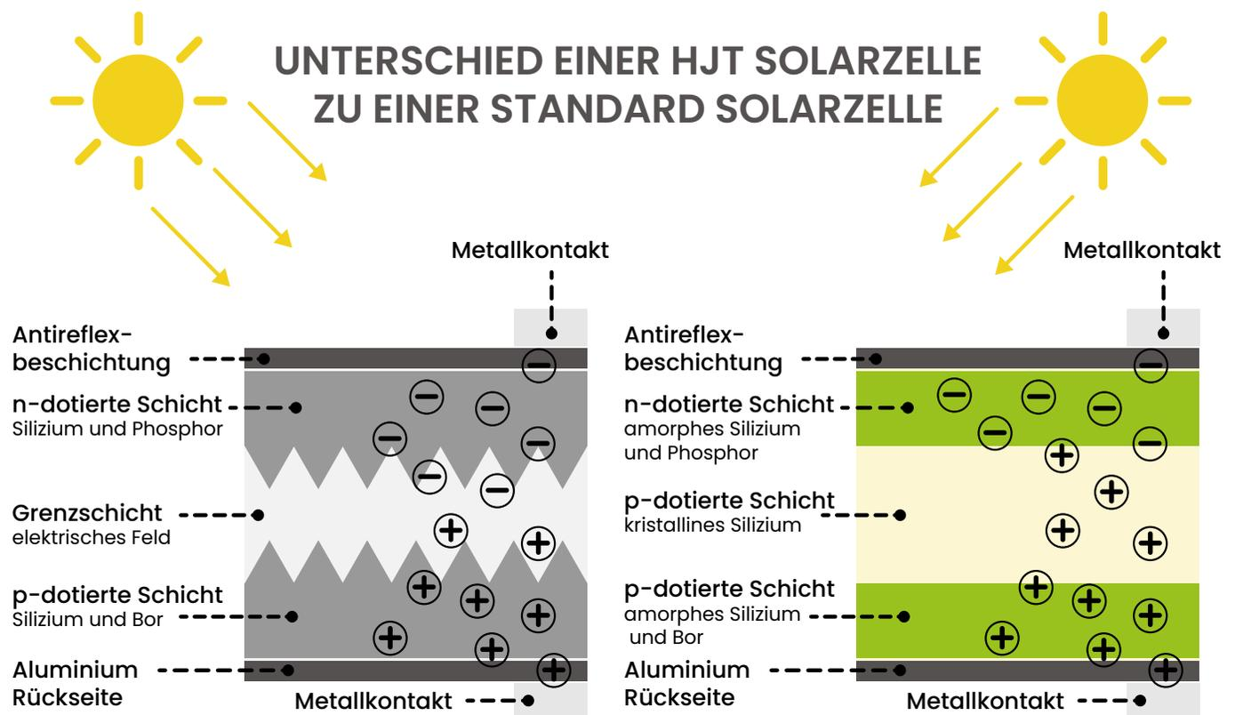
Sowohl HJT als auch bifaziale (zweiseitige) Solarzellen können einfallendes Licht über die Rückseite der Zelle nutzen. Bei HJT-Modulen sorgt die untere amorphe Schicht für die Lichtaufnahme über die Rückseite. Bei bifazialen Modulen ist es eine zweite Glasscheibe, die das indirekte Licht der reflektierten Sonnenstrahlen von hinten zurück in die Zelle lässt. Auf diese Weise wird bei beiden Solarmodultypen ein höherer Wirkungsgrad erzielt.
