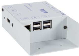
Der Multimediaplayer (Full HD) kann über DMX512 oder über das LAN-Netzwerk mittels UDP-Protokoll gesteuert werden. Er kann Multimedia-Dateien in allen gängigen Formaten abspielen. Die Dateien werden auf einem USB-Stick gespeichert. Das Gerät ist mit einem LAN-Anschluss ausgestattet. Über diesen erfolgt eine einfache Konfiguration mit einer PC-Anwendung. Es können auch ganze Playlisten, die DMX-Adresse und das Verhalten beim Ausfall der Ansteuerung festgelegt werden.
