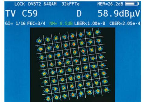
Messung DVB-T2 Transponder mit Anzeige des Konstellationsdiagrammes und der Noise Margin.
