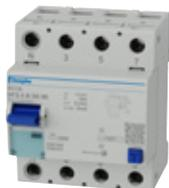
*allstromsensitiv Typ B, erhöht stoßstromfest, kurzzeitverzögert, gewitterfest, für mobile Installationen*
