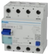
*allstromsensitiv Typ B, für Anlagen mit Frequenzumrichtern, USV-Geräten usw., erhöht stoßstromfest, kurzzeitverzögert, gewitterfest, Brandschutz bis 150 kHz, für Sonderspannung 500 V*
