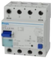
*allstromsensitiv Typ B, für Anlagen mit Frequenzumrichtern, USV-Geräten usw., erhöht stoßstromfest, kurzzeitverzögert, gewitterfest, Brandschutz bis 150 kHz*
