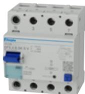
*allstromsensitiv Typ B, für Anlagen mit Frequenzumrichtern, USV-Geräten usw, erhöht stoßstromfest, gewitterfest, selektiv, für Sonderspannung 500 V*
