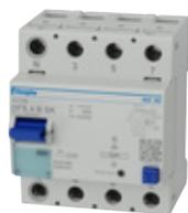
*allstromsensitiv Typ B, für Anlagen mit Frequenzumrichtern, USV-Geräten usw., erhöht stoßstromfest, kurzzeitverzögert, gewitterfest, für raue Umgebungen, prüfungsfest*
