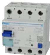
*allstromsensitiv Typ B, für Anlagen mit Frequenzumrichtern, USV-Geräten usw., erhöht stoßstromfest, kurzzeitverzögert, gewitterfest, für raue Umgebungen*
