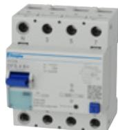
*allstromsensitiv Typ B+, für Anlagen mit Frequenzumrichtern, USV-Geräten usw., erhöht stoßstromfest, kurzzeitverzögert, gewitterfest, Brandschutz bis 20 kHz*
