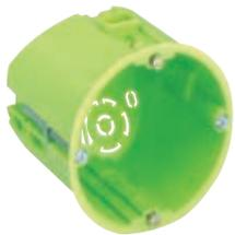
Hohlwand-Geräteverbindungsdose, flammwidrig, mit vergrößertem Anschlussraum, Universaldose für Plattenstärken von 1 bis 40 mm, mit Lochwerkzeug, Geräteschraubenabstand 60 mm, halogenfrei
