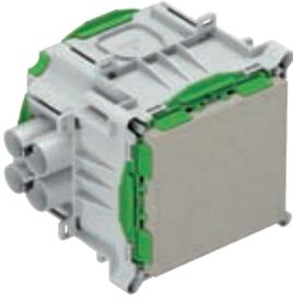
Universelles Einbaugehäuse, für Fertigteilbau, halogenfrei, zum Einbau von NV/HV/LED-Leuchten und Lautsprechern, Melde- und Rufsystemen, geeignet für Klebefestigung, für die Installation von VDE geprüften Leuchten nach DIN EN 60598 (VDE 0711), sowie mit F-Kennzeichnung oder MM-Kennzeichnung, maximale Einbauhöhe für Leuchten, Lautsprecher, Melde und Rufsystemen: 100 mm, Lampenleistung: LED max. 15 W, Halogen max. 25 W, 2 zusätzliche Einführungen bis M40
