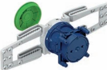
Bewehrungsdose, 2-teilig, rückwärtig Boden grün mit Einführung max. 1x 25 mm , kombinierbar, geeignet für Gegenschalung ohne Abstützung, Vormontage in der Bewehrung, für den Betoneinbau, kombinierbar im Normabstand 71 mm
