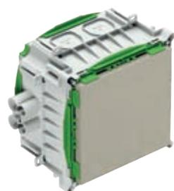
Universelles Einbaugehäuse, für Fertigteilbau, halogenfrei, zum Einbau von NV/HV/LED-Leuchten und Lautsprechern, Melde- und Rufsystemen, geeignet für Klebefestigung, für die Installation von VDE geprüften Leuchten nach DIN EN 60598 (VDE 0711), sowie mit F-Kennzeichnung oder MM-Kennzeichnung, maximale Einbauhöhe für Leuchten, Lautsprecher, Melde und Rufsystemen: 100 mm, Lampenleistung LED max. 20 W, 4 zusätzliche Einführungen bis M40
