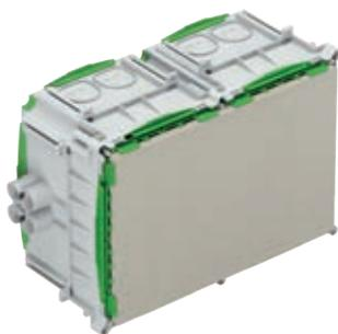
Universelles Einbaugehäuse, für Fertigteilbau, halogenfrei, zum Einbau von NV/HV/LED-Leuchten und Lautsprechern, Melde- und Rufsystemen, geeignet für Klebefestigung, für die Installation von VDE geprüften Leuchten nach DIN EN 60598 (VDE 0711), sowie mit F-Kennzeichnung oder MM-Kennzeichnung, maximale Einbauhöhe für Leuchten, Lautsprecher, Melde und Rufsystemen: 130 mm, Lampenleistung: LED max. 47 W, Halogen max. 100 W, 8 zusätzliche Einführungen bis M40
