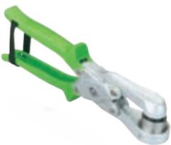
Stanzzange, Lochwerkzeug zur Erstellung passgenauer Einführungen in Betondosen, Lochung immer 1-3 mm kleiner als Rohr-/Leitungsdurchmesser
