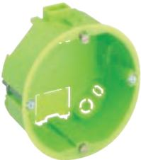
Hohlwand-Flachdose, flammwidrig, Spezialdose mit geringer Einbautiefe (35 mm), für dünne Wände mit Plattenstärken von 1 bis 20 mm, mit angespritzten, patentierten Kombibrücken, Geräteschraubenabstand 60 mm, halogenfrei
