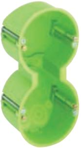
Hohlwand-Gerätedoppeldose, flammwidrig, für Plattenstärken von 1 bis 40 mm, mit Lochwerkzeug, Geräteschraubenabstand 60 mm
