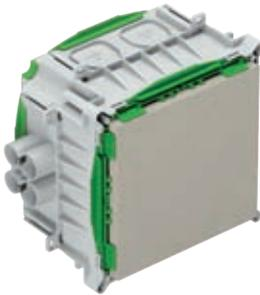
Universelles Einbaugehäuse, für Fertigteilbau, halogenfrei, zum Einbau von NV/HV/LED-Leuchten und Lautsprechern, Melde- und Rufsystemen, geeignet für Klebefestigung, für die Installation von VDE geprüften Leuchten nach DIN EN 60598 (VDE 0711), sowie mit F-Kennzeichnung oder MM-Kennzeichnung, maximale Einbauhöhe für Leuchten, Lautsprecher, Melde und Rufsystemen: 100 mm, Lampenleistung: LED max. 20 W, Halogen max. 50 W, 4 zusätzliche Einführungen bis M40
