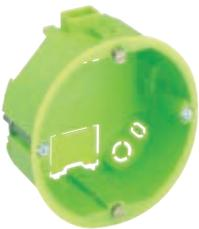
Hohlwand-Flachdose, flammwidrig, Spezialdose mit geringer Einbautiefe (35 mm), für dünne Wände mit Plattenstärken von 1 bis 20 mm, mit angespritzten, patentierten Kombibrücken, Geräteschraubenabstand 60 mm
