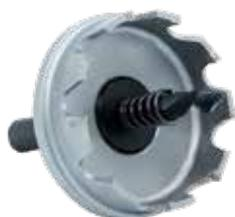
Lochfräser für Hand- und Säulenbohrmaschinen, hochwertige Industrieausführung mit Hartmetallschneideplatten für hohe Schnittleistung, mit Zentrierbohrer (auswechselbar) und Auswurffeder
