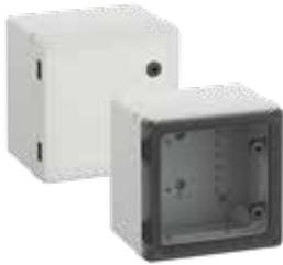
Schaltschrank - Industrie Qualität, geeignet für die Installation in rauen Umgebungen und im ungeschützten Außenbereich, Kasten und Rahmen: glasfaserverstärktes Polycarbonat, grau, ähnlich RAL 7035, Tür: Polycarbonat, Drehriegelverschluss mit 3mm Doppelbarteinsatz (austauschbar) nach DIN 43668
