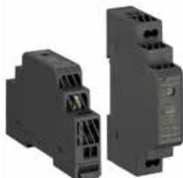
Netzteil zur Montage auf Normschiene NS35. Eingangsspannung 85V bis 264 V AC, Ausgangsspannung 21,6 V -29 V DC. Leistung max. 15,2 W.
