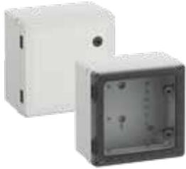
Schaltschrank - Industrie Qualität, geeignet für die Installation in rauen Umgebungen und im ungeschützten Außenbereich, Kasten und Rahmen: glasfaserverstärktes Polycarbonat, grau, ähnlich RAL 7035, Tür: Polycarbonat, Drehriegelverschluss mit 3mm Doppelbarteinsatz (austauschbar) nach DIN 43668
