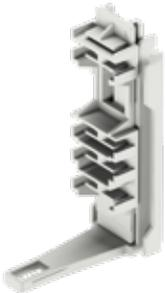
Montagehalter-Set, zur werkzeuglosen Montage von Normschienen 35 x 7,5 mm und Montageplatten in unterschiedlichen Höhen, zusätzliche obere Position für die Montage von Reiheneinbaugeräten in Verbindung mit Klappfenstern im Deckel von Leergehäusen, Set = 4 Stück
