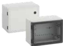
Schaltschrank - Industrie Qualität, geeignet für die Installation in rauen Umgebungen und im ungeschützten Außenbereich, Kasten und Rahmen: glasfaserverstärktes Polycarbonat, grau, ähnlich RAL 7035, Tür: Polycarbonat, grau, ähnlich RAL 7035, Tür: Polycarbonat. Drehriegelverschluss mit 3mm Doppelbarteinsatz (austauschbar) nach DIN 43668
