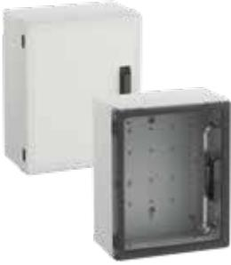
Schaltschrank - Industrie Qualität, geeignet für die Installation in rauen Umgebungen und im ungeschützten Außenbereich, Kasten und Rahmen: glasfaserverstärktes Polycarbonat, grau, ähnlich RAL 7035, Tür: Polycarbonat. Schwenkhebel zur Aufnahme von Profilhalbzylinder nach DIN 18252
