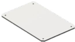
Einbauplatte aus Isolierstoff für die Tür von GEOS-Schaltschränken, inkl. Befestigungsschrauben, zur individuellen Verwendung, z.B. zum Einbau von Anzeigeelementen und Displays, Materialstärke: 4 mm
