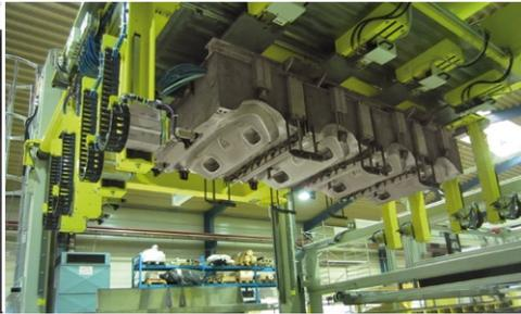
Bei unseren Verformpressen sind einfach- oder doppelwirkende Lösungen mit Presskräften von 20 Tonnen bis zu 500 Tonnen möglich.
