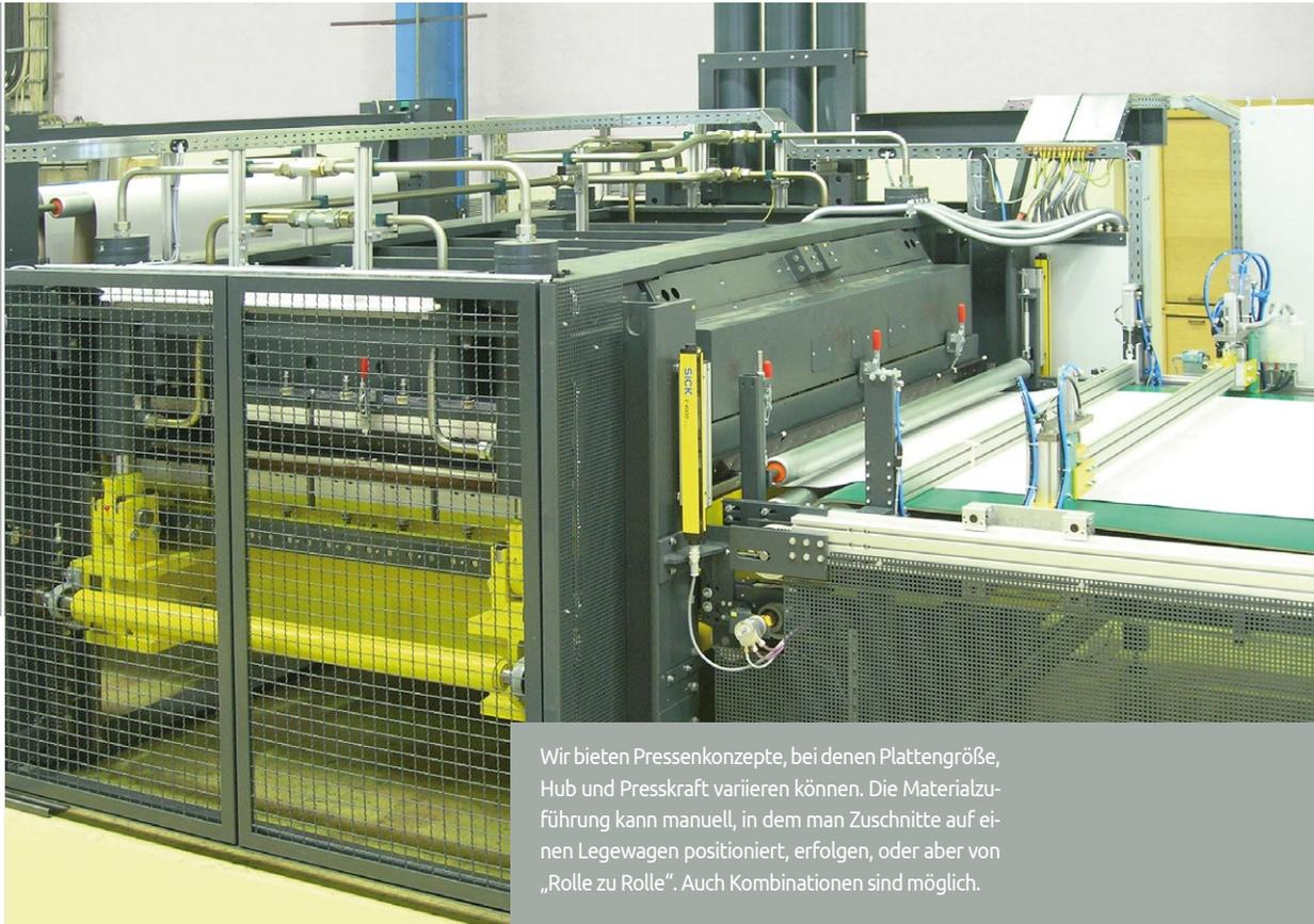
Wir bieten Pressenkonzepte, bei denen Plattengröße, Hub und Presskraft variieren können. Die Materialzuführung kann manuell, in dem man Zuschnitte auf einen Legewagen positioniert, erfolgen, oder aber von „Rolle zu Rolle“. Auch Kombinationen sind möglich.
