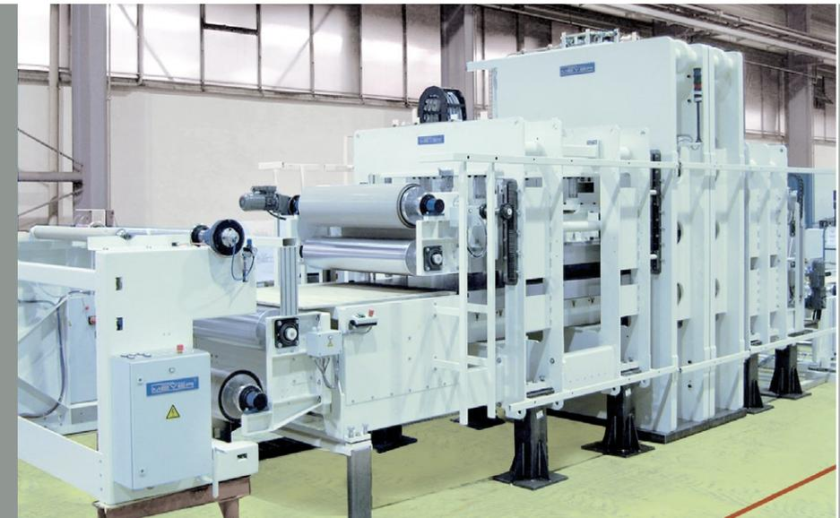
Besonderheit der Sheeter-Pressen ist der getaktete Prozess. Das Transportsystem taktet die Materialien durch die Heiz- und Kühlpressen, wobei Drücke bis 70 bar realisiert werden können.
