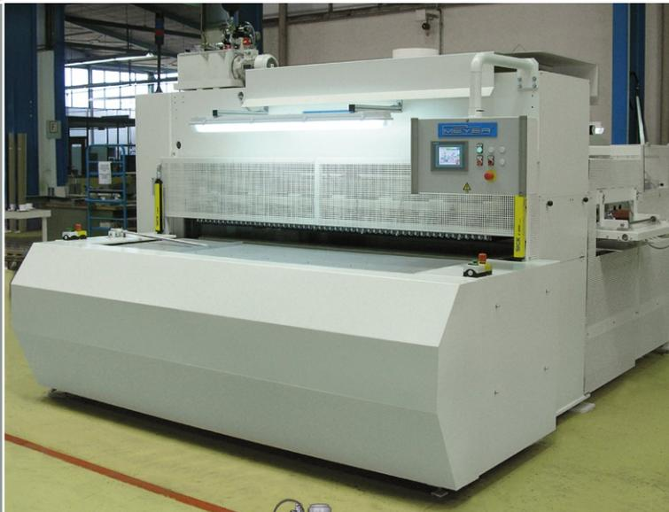
In der Heizpresse wird das Thermodruck-Trägermaterial auf das zu bedruckende Material gelegt und zusammen aufgeheizt. Die hohen Temperaturen und der hohe Druck in der Presse ermöglichen, dass die Farbpigmente sublimieren, d.h. in den gasförmigen Zustand wechseln, dabei tief in das zu bedruckende Material eindringen können.
