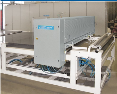
Querschneider, mitfahrend mit Kreismesser oder Ziehklinge
