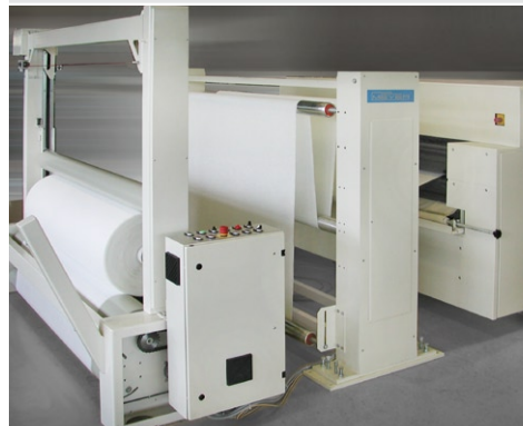
Steigdocken-Wickler mit Tänzer zur Kontrolle der Zugspannung
