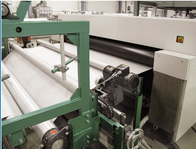
Kantenbesäumung mit einstellbarer Breite
