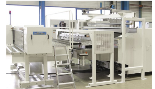
Pulverstreuer mit IR-Heizfeld
