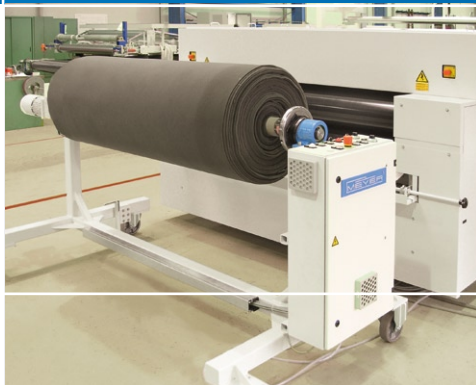
Elektrischer Wickler mit Zugspannungsregelung
