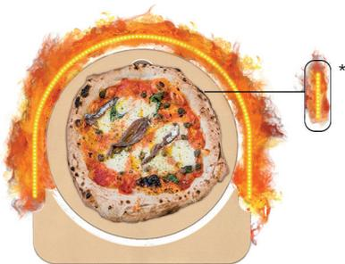
Der U-förmige Brenner mit 8,5 kW Leistung sorgt für eine gleichmäßig hohe Temperatur beim Pizzabacken. Pizzastein batteriebetrieben oder alternativ mit mitgeliefertem Stromanschluss.
