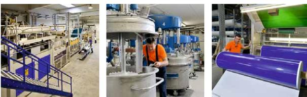
Mit unseren hochleistungsfähigen Beschichtungsanlagen haben wir die Möglichkeit mit PUR-Lösungen, wässrigen Dispersionen und PVC-Plastisolen sowohl im Direkt- als auch im Indirektstreichverfahren zu arbeiten.
