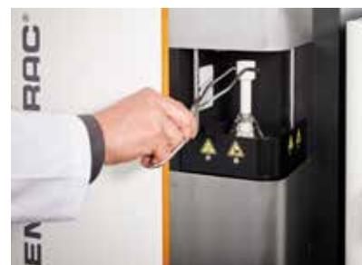
Der mit Probe und Zuschlägen gefüllte Tiegel wird auf den Probenständer des ELEMENTRAC CS-i gestellt
