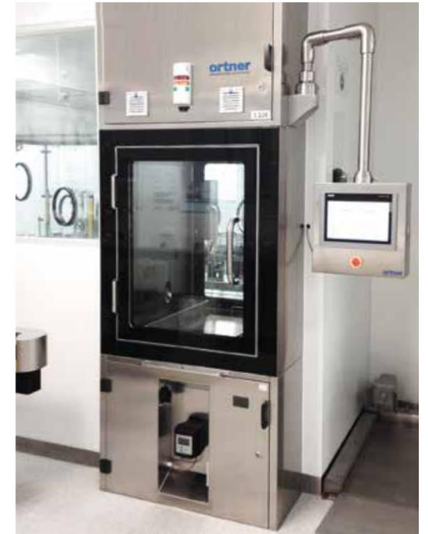
H<sub>2</sub>O<sub>2</sub>-Dekontaminationsschleuse in dem Ausgangsbereich
