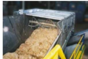
Stazione di stoccaggio e di alimentazione per piume, completa di nastro trasportatore.
