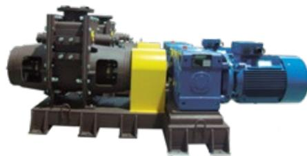
Progettata per risolvere i problemi di trasporto dei prodotti pastosi, umidi, con un'alta viscosità e di una certa granulometria (fino a pezzature di 50mm) attraverso i condotti ermetici che eliminano i problemi di odori e di contaminazione con l'esterno. La macchina è fornita inoltre di un'appropriata tramoggia di alimentazione per garantire il continuo flusso del prodotto da trasportare.
