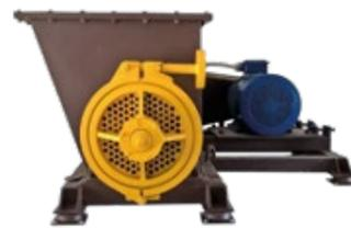
Impiegato per la tritatura della carne e scarti di macellazione al fine di ottenere la pezzatura desiderata e facilitarne il trasporto (con elettropompe e coclee) e soprattutto le operazioni di sterilizzazione, cottura ed essiccaamento.
