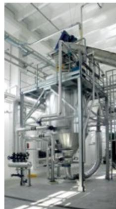
Sistema di stoccaggio con gestione del peso ed alimentazione rapida per cuocitori continui e discontinui che riduce in pochi secondi il tempo di carico degli stessi.
