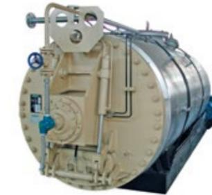
Sterilizzatore e cuocitore discontinuo per la lavorazione dei sottoprodotti della macellazione grezzi o semilavorati.
