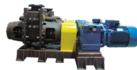
Progettato per risolvere i problemi di trasporto dei prodotti pastosi, umidi, con un'alta viscosità e di una certa granulometria (fino a pezzature di 50mm) attraverso i condotti ermetici che eliminano i problemi di odori e di contaminazione con l'esterno. La macchina è fornita inoltre di un'appropriata tramoggia di alimentazione per garantire il continuo flusso del prodotto da trasportare.
