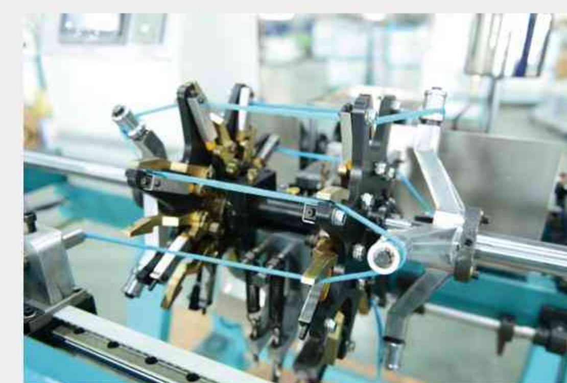
数控全自动轧头机 PLC automatic tipping machine
