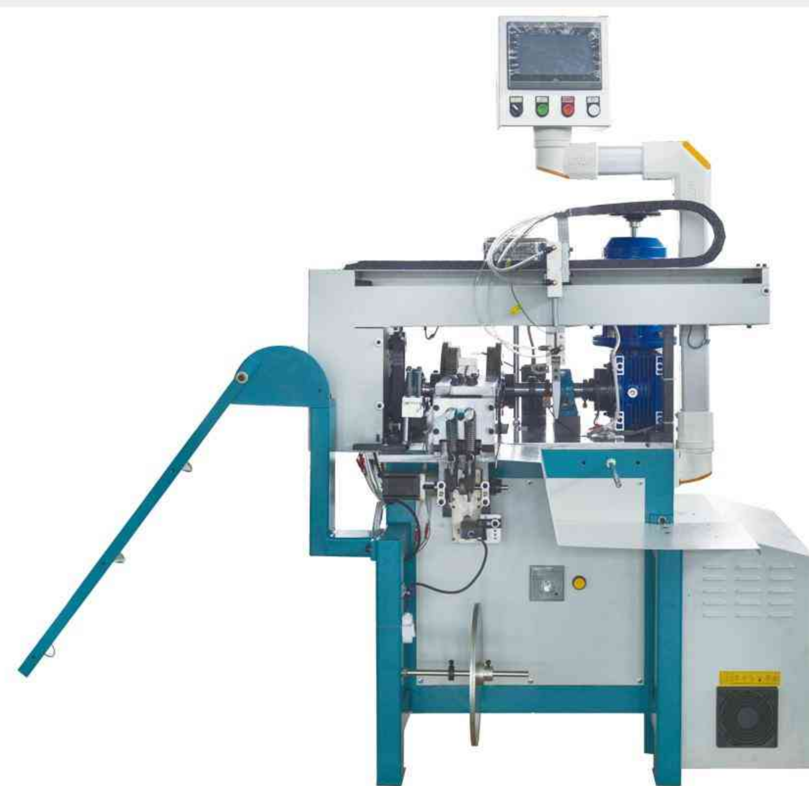
机械手全自动轧头机 Manipulator type automatic tipping machine
