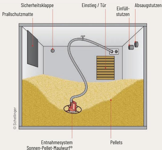
In Häusern, in denen bisher eine Ölheizung für Wärme sorgte, bietet sich die Lagerung der Pellets im klassischen Kellerraum an. Oft kann der Raum, in dem der Öltank stand, als Pelletlagerraum umgebaut werden. Auf die bisher üblichen Schrägen kann durch den Einbau des Sonnen-Pellet Maulwurfs verzichtet werden. Der verwendete Lagerraum muss über eine ausreichende Hinterlüftung verfügen.
