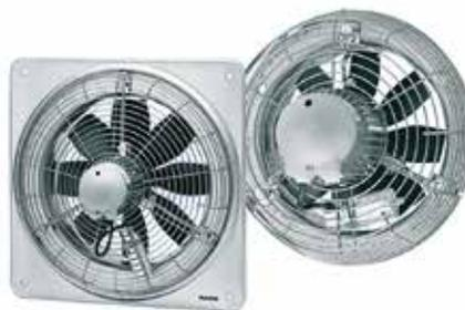
Der Ventilator saugt die warme Abluft in Deckennähe ab. Kühlere Zuluft strömt durch das Nachström-/ Außen-gitter in Bodennähe nach. Ein Zuluftfilter (z. B. ZFF) filtert die Staub- und Schmutzpartikel aus der Zuluft heraus, um die empfindlichen elektrischen oder elektronischen Anlagen im Raum vor Schäden zu schützen.
