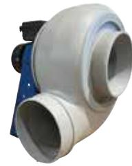
Im vorliegenden Beispiel wird diese belastete Luft direkt über ein Wickelfalzrohr aus der Spritzgussanlage abgeführt. Somit bleibt die Raumluft sauber und unbelastet. Das Radial-Gebläse GRK ist ein druckstarker Ventilator, welcher die Abluft hier direkt aus der Maschine saugt und in den Abluftkanal bläst. Da der Motor sich außerhalb des Luftstroms befindet und das Gehäuse aus Kunststoff besteht, ist das Radial-Gebläse auch besonders zur Förderung von korrosiven und säurehaltigen Medien geeignet.
