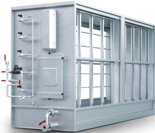
Durchlaufwassersprühbefeuchtern ist gemeinsam, dass die innerhalb des Luftstroms zerstäubte Wassermenge nur wenig über dem für die Befeuchtung erforderlichen Wasserstrom liegt. Der geringe Anteil nicht verdunsteten Wassers wird nicht zurückgeführt und erneut zerstäubt sondern als Verwurf dem Abwassersystem zugeführt.
