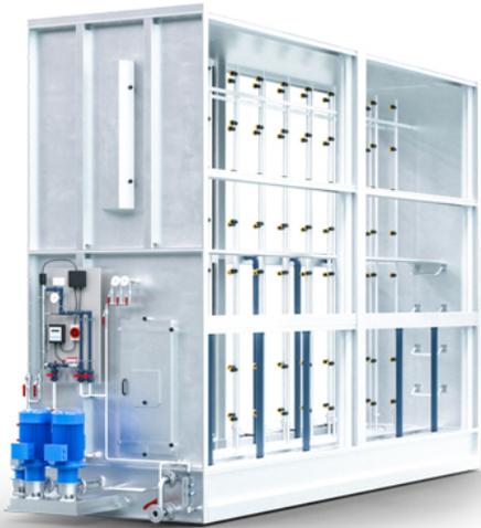
Der Umlaufwassersprühbefeuchter, auch als Luftwäscher bezeichnet, ist der Klassiker unter den Befeuchtungssystemen. Die innerhalb des Luftstroms zerstäubte Wassermenge liegt um ein Vielfaches über dem für die Befeuchtung erforderlichen Wasserstroms. Das nicht verdunstete Wasser wird in einem Behälter aufgefangen und erneut den Düsen zugeführt. Der Verlustwasseranteil ist durch die Rezirkulation des Wassers somit theoretisch betrachtet bei 0%.
