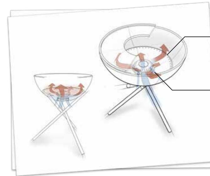
Der Lochkreis am Außendurchmesser ermöglicht hinreichende Ventilation im äußeren Bereich
