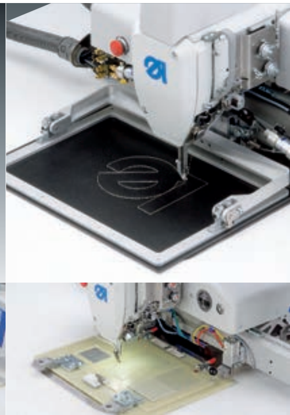
Unidad de costura a mando CNC con pinzas intercambiable para un modo de trabajo superpuesto – campo de costura máx. 380 x 200 mm
