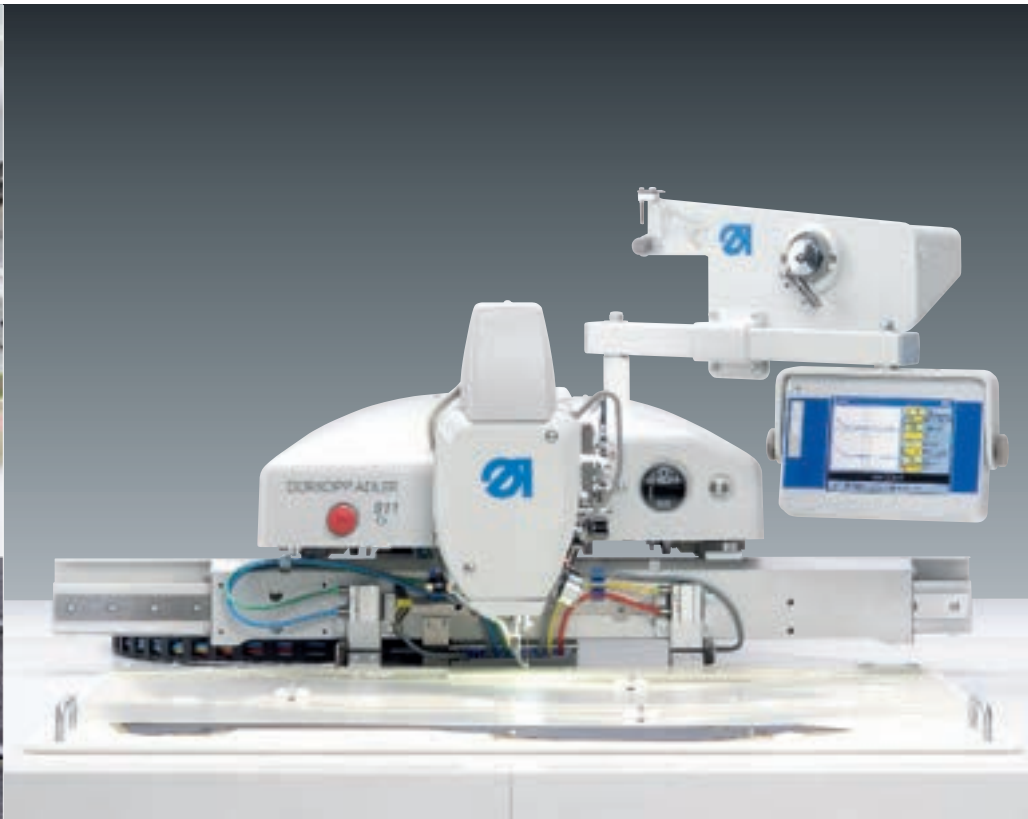
CNC-gesteuerte Nähanlage mit Wechselklammer – Nähfeldgröße max. 600 x 200 mm
