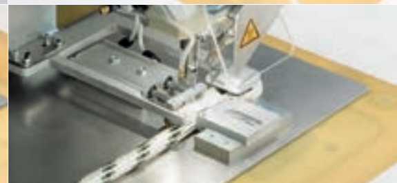
Unidad de costura a mando CNC con sistema de pinzas para la fabricación de correas de trincar – campo de costura máx. 200 x 100 mm
