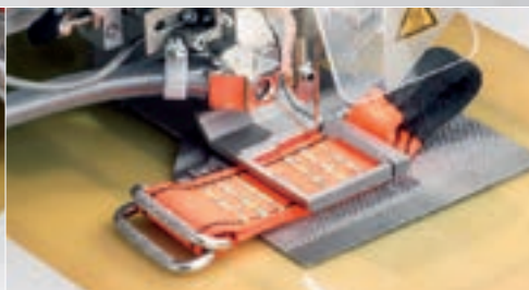
CNC-gesteuerte Nähanlage mit Klammersystem zur Herstellung von Zurrgurten – Nähfeldgröße max. 200 x 100 mm
