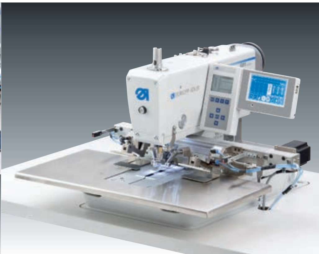
Augenknopfloch-Indexer für Ärmelschlitz oder Kleinteile wie z. B. Jeans-Schlitzleisten
