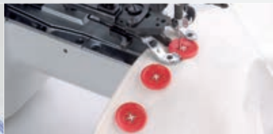
Automáta botonadora, de doble respunte, con mando CNC con tecnología de motor paso a paso
