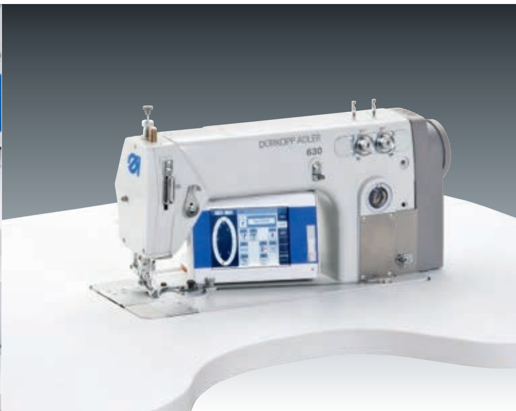
Máquina especial para prefundido programado de la copa de manga con fijación
